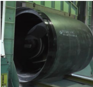
RJC RM (6P) 1710 外圧試験状況
