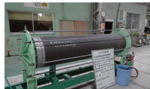
内水圧試験状況写真 小口径管
