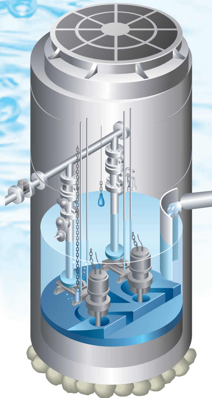
マンホールポンプを設置した4号マンホールのイメージ
