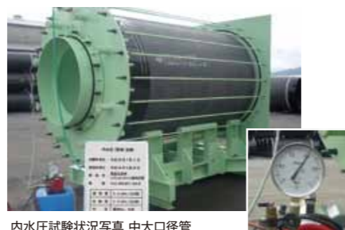
内水圧試験状況写真 中大口径管
