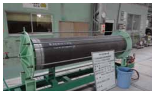
内水圧試験状況写真 小口径管
