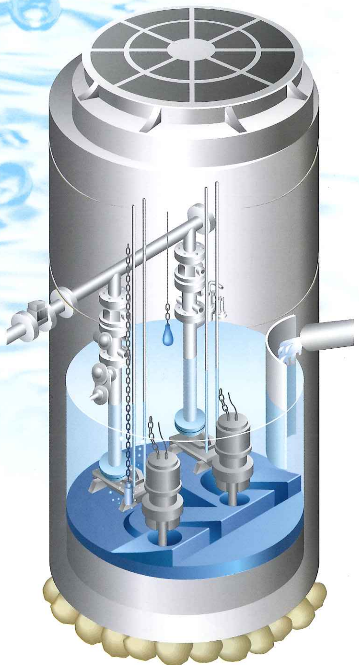
マンホールポンプを設置した4号マンホールのイメージ
