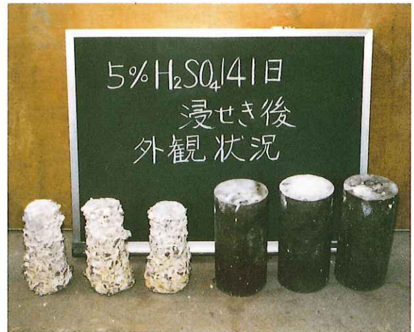
左:セメントコンクリート 右:レジンコンクリート
